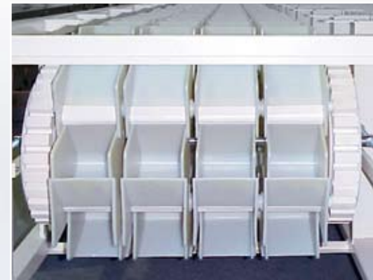
Mehrfühiges Becherband an der Spannstation
